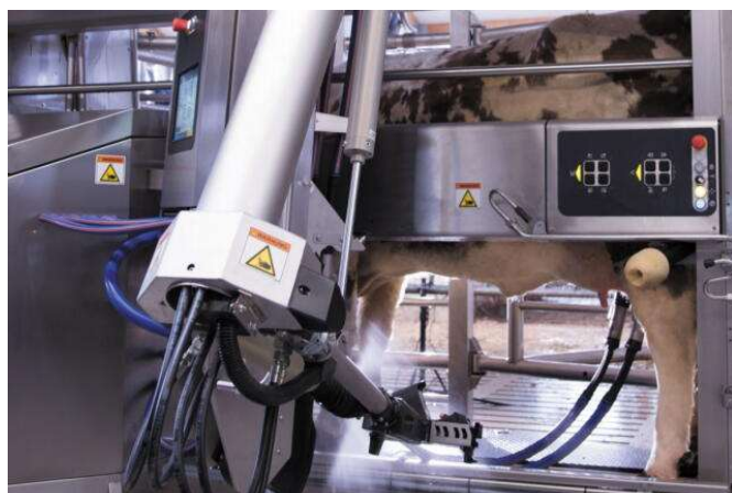
Robotické rameno pro přesné a rychlé nasazení struků.
